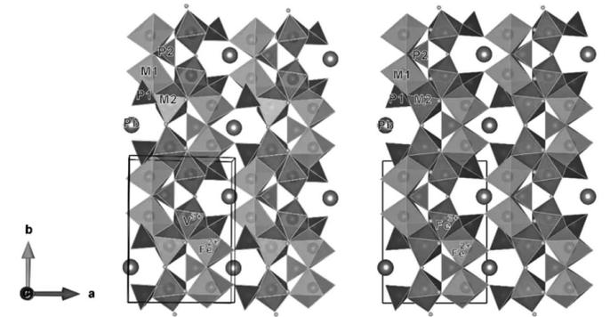
褐磷钒铁铅石(a)和绿磷铁铅石(b)的晶体结构图
